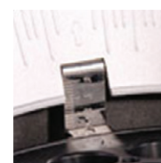
Escala de ângulo para ajuste mais preciso.
